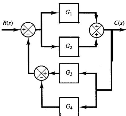
**Figura 3-50** Diagrama de Bloques de un sistema.
