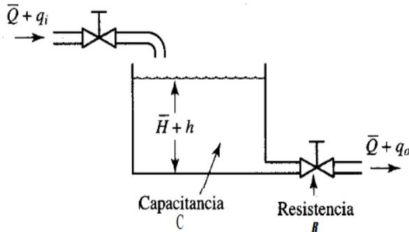
**B-3-13** Considere un sistema de nivel de líquido de la figura 3-60. Suponiendo que  $\bar{H}=3\text{cm}$ ,  $\bar{Q}=0.02\text{m}^3/\text{seg}$ , y que el área transversal del tanque es igual a  $5\text{m}^2$ , obtenga la constante de tiempo del sistema en el punto de operación  $(\bar{H}, \bar{Q})$ . Suponga que el flujo a través de la válvula es turbulento.
