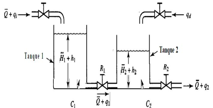
**Figura 3-62** Sistema de nivel de líquido.
